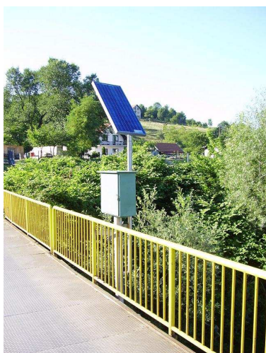
Slika 3 i 4: Samostojeći fotonaponski sistemi za praćenje parametara rijeka
