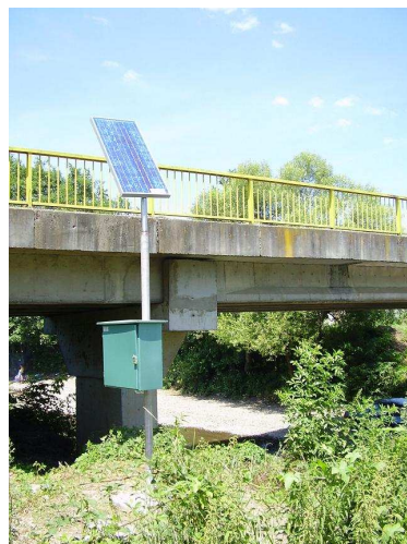
Slika 3 i 4: Samostojeći fotonaponski sistemi za praćenje parametara rijeka
