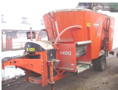
Slika br. 19. Mikser – specijalno priključno vozilo za dostavu silaže
