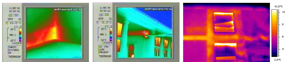
Slika 2.20. Karakteristični primjeri toplinskih mostova na neizoliranim zgradama
